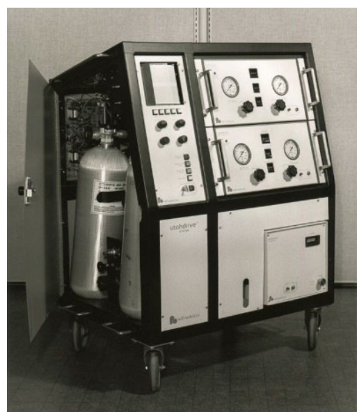
Steuerelement für das pneumatische Jarvik 7 Kunstherz [10]
